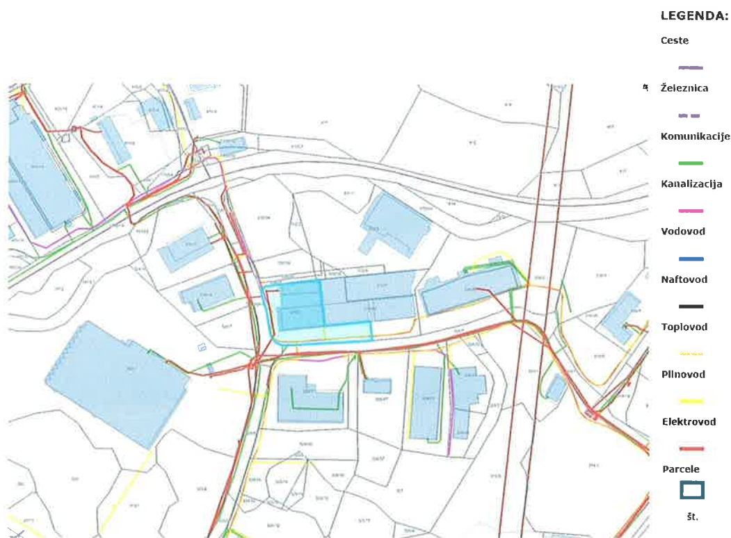
Slika 3 (VIR: PISO, december 2020): Prikaz gospodarske infrastrukture. Območje LP očrtano z svetlo modro črto. Objekt je priključen na gospodarsko javno infrastrukturo.
